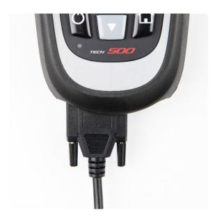
Der **DB15-Stecker** verbindet das Werkzeug mit dem OBD Kabel.
