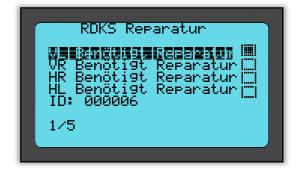
Die "Speichern" Option ermöglicht eine Abspeicherung der Daten auf dem Werkzeug. Von dort können die Daten dann auf Ihren PC übertragen werden. Die "Bearbeiten" Option ermöglicht eine Radposition zu kennzeichnen, welche einen mechanischen Defekt hat zum Beispiel ein korrodiertes Ventil.
