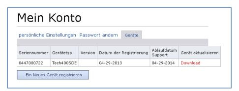
Wenn Sie Download auswählen wird eine Softwareversion speziell für diese Seriennummer generiert. Diese Datei funktioniert auch nur mit dem angegebenen Werkzeug.
