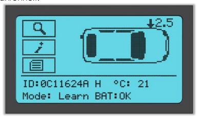
Der Pfeil springt dann automatisch zur nächsten Radposition (Vorne Rechts, Hinten Rechts und Hinten Links), der Reifendruck wird direkt neben der Radposition angezeigt. Die Einheit (Bar oder PSI) kann in den Einstellungen gewählt werden.
