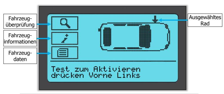
Der Fortschritt im Testvorgang wird anhand eines Ladebalkens angezeigt, die Maximaldauer für ein erfolgreiches Lesen ist hierbei die Bildschirmbreite. Unterschiedliche Modelle von RDK Sensoren variieren in den Antwortzeiten/intervallen.
