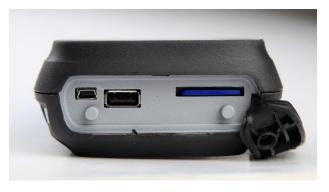
**USB-Anschluss** zum Aufladen des Akkus, für Software-Updates und zum Anschauen und Speichern der Kontrolldatei.
