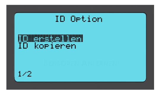
Nachdem Sie "ID erstellen" oder "ID kopieren" ausgewählt haben, werden Sie aufgefordert den richtigen Sensoren vor dem Werkzeug zu platzieren damit diese programmiert werden können. Das Verfahren kann von Sensor zu Sensor variieren jedoch hilft das Werkzeug mit klaren Anweisungen.
