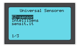
Für dieses Beispiel wurde der 'EZ-sensor' gewählt. Da der linke vordere Sensor schon gelesen wurde und die ID bekannt ist wird die Option des Kopierens angeboten. Bei dem Kreieren wird eine neue ID vergeben. Wenn alle Sensoren gelesen wurden, wird bei allen die Kopieroption zur Verfügung stehen.
