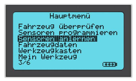
Um die Sensoren anlernen zu können, müssen Sie zuerst den Fahrzeughersteller, das Modell und das Jahr auswählen. Siehe Menüpunkt "FAHRZEUG ÜBERPRÜFEN". Anschließend befolgen sie die Anleitung auf dem Bildschirm.
