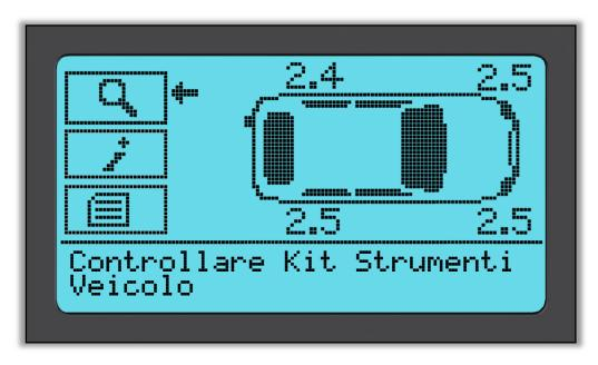
Se si ritorna allo schermo di Controllo veicolo, si possono utilizzare i tasti freccia per spostare la freccia sul Kit Strumenti Controllo Veicolo e premere il pulsante Invio.
