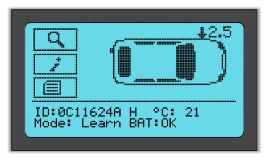
La freccia si sposterà automaticamente sulla posizione ruota successiva (Anteriore DX, Posteriore DX e quindi Posteriore SX), e la pressione sarà visualizzata rispetto alla posizione della ruota precedente, in Bar o PSI come selezionata in Impostazioni.
