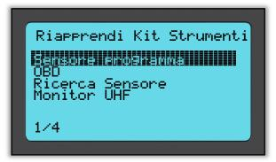
In questo caso il sensore anteriore sinistro è già stato letto, ma è necessario sostituirlo. Dopo la lettura, utilizzare il testo freccia giù per navigare al 'Riapprendi Kit Strumenti' quindi 'Programm. Sensore' e selezionare il sensore programmabile che si desidera utilizzare.
