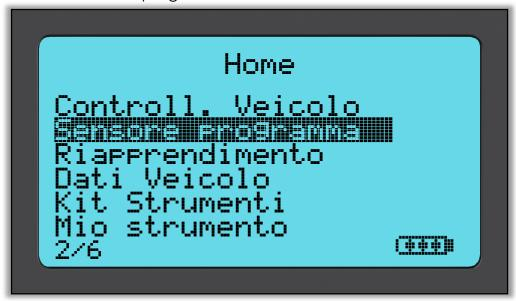
Per programmare un sensore correttamente, il veicolo utilizzato deve essere selezionato utilizzando Marca-Modello-Anno. La procedura per selezionare Marca-Modello-Anno e l'inserimento della targa (se richiesto) è la stessa di quella descritta nella sezione **Controllo veicolo**.
