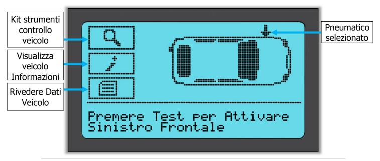
Durante il test, lo schermo conferma il tipo di sensore su cui si deve eseguire il test e visualizza una barra di avanzamento. La larghezza dello schermo mostra il tempo massimo possibile per una lettura corretta - marche diverse di TPM rispondono ad intervalli di velocità/tempo diversi.
