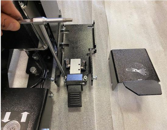
3. Setzen Sie den Schlauch mit Anschluss (S) in das Pedal ein.
