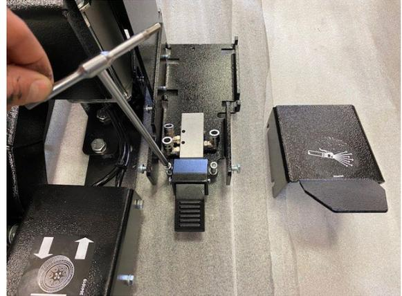
3. Setzen Sie den SCHWARZEN Schlauch mit Anschluss (S) in das Pedal ein.
