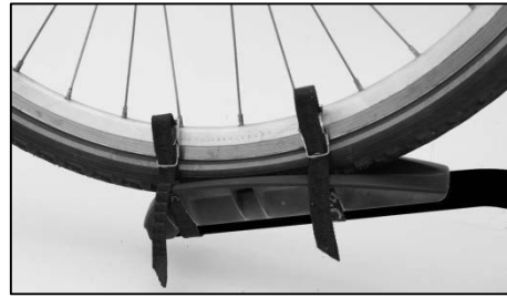
Figure 15 : Sangles de sécurité de la roue avant
