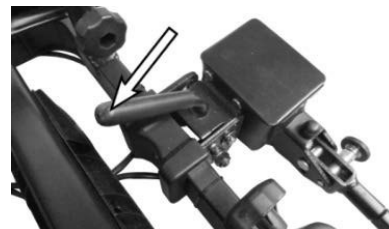
Figure 17 : Mécanisme de pliage
