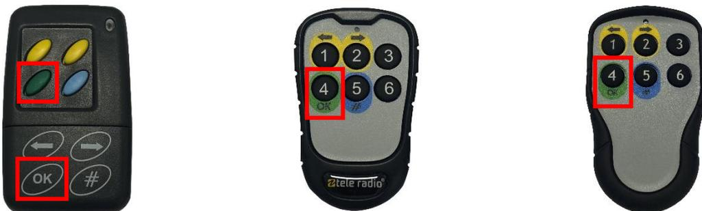
Premendo il tasto verde del telecomando è possibile modificare manualmente l'assegnazione dei convertitori di pressione ad un numero di asse se non è presente alcun asse sul set di rulli del banco prova.
