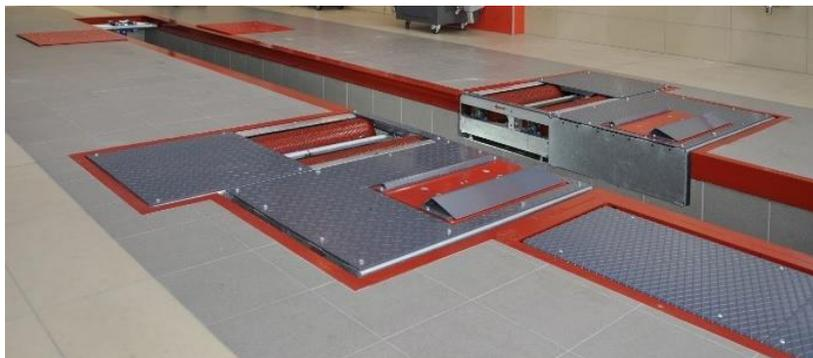
Montaggio sotto al livello del pavimento (come parte di una linea di diagnosi), con buca di lavoro
