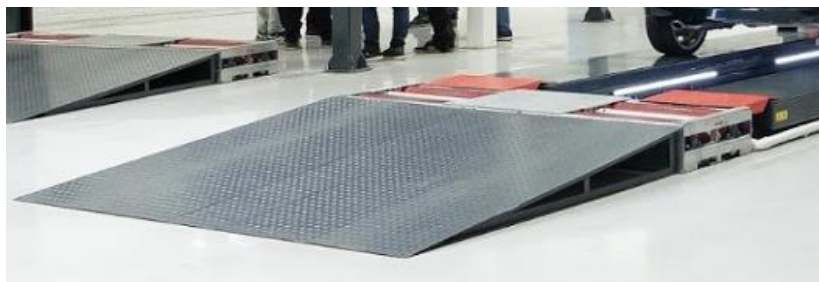
Einbau überflur Bauweise Kompakt
