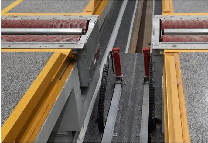
La simulation de charge avec dispositif de pesage permet de simuler des charges d'essieu supérieures. Pour ce faire, deux vérins hydrauliques sont utilisés : chacun est équipé d'une sangle de serrage du commerce présentant une force de serrage admissible au moins égale à la moitié de la charge d'essieu simulée.
