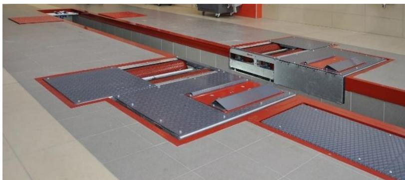
Montage encastré (dans le cadre d'une piste d'essai), avec fosse de travail
