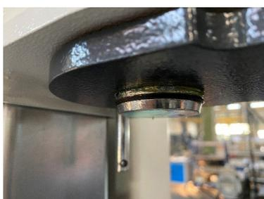
Fissaggio inferiore del bullone del braccio portante
