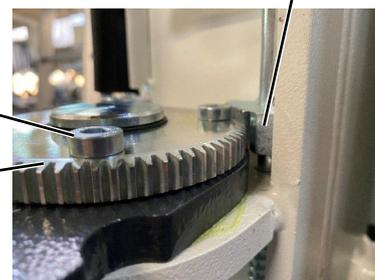
**Nota 1:** Per ragioni tecniche, può succedere che un dente del segmento dentato poggi sulla puleggia dentata durante il bloccaggio e che quindi il blocco del braccio articolato non si blocchi. Un leggero movimento orizzontale del braccio portante deve poi inserirsi nella serratura.
