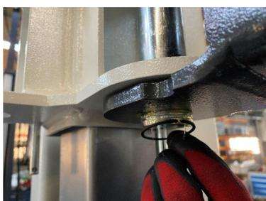
Montare l'anello di sicurezza nella parte inferiore
