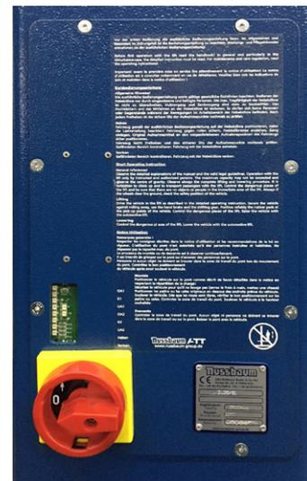
Bild 4 Bedieneinheit mit Wendeschalter (2.30 SL bis 2.40 SL)
