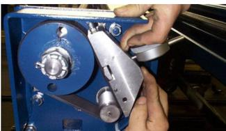
Bild 17: Messgerät am Riemen anlegen
