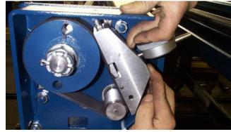
Figure 17 : Positionner l'appareil de mesure sur la courroie
