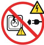
Das Ladegerät niemals an eine beschädigte, lockere oder verschlissene Netzsteckdose anschließen.
