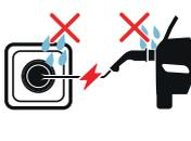
Darauf achten, dass während des Ladevorgangs kein Wasser in die Netzsteckdose oder den Ladeanschluss vom Fahrzeug gelangt.
