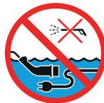
Stecker von Wasser fernhalten. Stecker keinem direkten Wasserstrahl oder Spritzwasser aussetzen.
