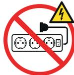
Keine Verlängerungskabel, Mehrfachsteckdosen oder Adapter verwenden.
