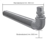
Das mitgelieferte Füllventil mit Anschlussgewinde G½ soll mit einem Wandabstand von min. 200 mm und einem Bodenabstand von min. 600 mm senkrecht montiert werden. Die Verwendung eines G½-Stahlrohres mit 90°-Winkel wird zur Erreichung ausreichender Stabilität empfohlen.
