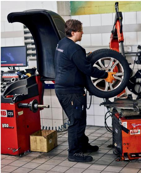
Reifenmontiermaschine und Auswuchtmaschine stehen nahe beieinander. **Damit sind die Transportwege kurz.**
