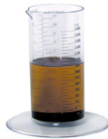
Contaminazione Deposito nell'olio dell'impianto
