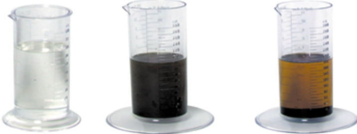
Verschmutzung Ablagerungen im Öl
