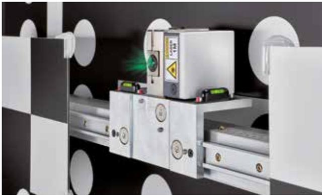
Linien-Lasermodul am Präzisionsmessbalken SCT 1415
