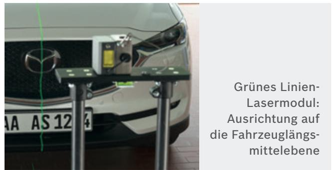
Grünes Linien-Lasermodul: Ausrichtung auf die Fahrzeuglängsmittlebene
