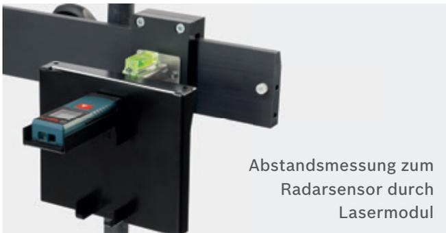
Abstandsmessung zum Radarsensor durch Lasermodul
